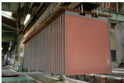
パーマナントカソード法による電気銅
